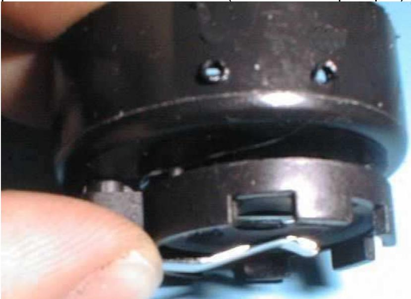
Ripetiamo la stessa operazione sul lato sinistro, dopodichè infiliamo i LED facendo attenzione a rispettare la polarità (il piedino lungo del LED deve essere nel foro dalla parte del polo positivo del portapila (solitamente è quello che arriva dalla parte superiore della pila).
