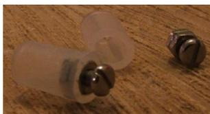
Figura 5: Le viti metriche, i dadi e il tubo in plastica.
