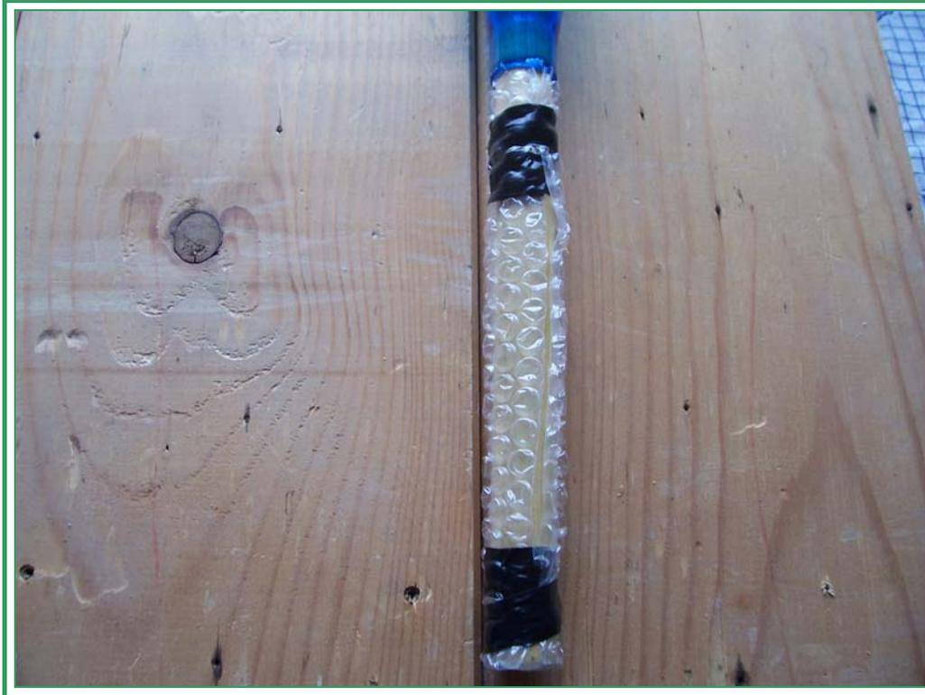
6) Avvolgere con il nastro isolante il manico, girando e tirando con un po' di forza intorno alla carta, in modo da creare un manico comodo e ben impugnabile; Inserite il tappo di gomma alla fine del manico;
